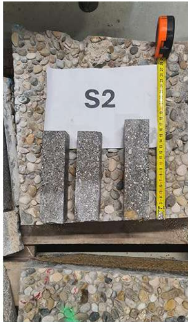
Abbildung 90: Geschnittene Proben für Materialprüfung, TU Wien
