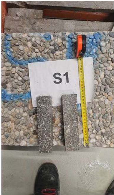
Abbildung 90: Geschnittene Proben für Materialprüfung, TU Wien
